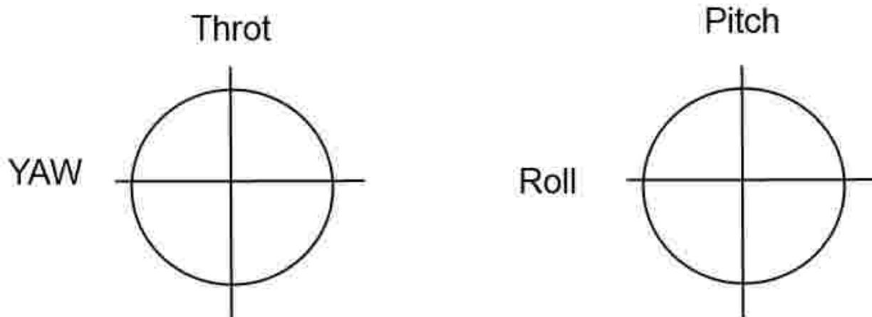
Нужно включить передатчик, и пошевелить ручками, если есть ручки которые установлены неправильно, следует поменять назначение каналов на приемнике.
