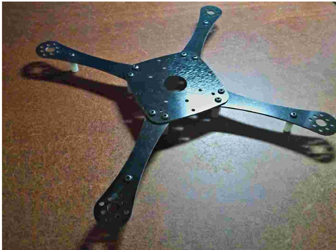
Ребра жесткости крепятся к лучам, и все фиксируется второй платформой.
